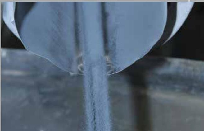
Notre procédé de séchage par pulvérisation, basé à l'eau, mis en œuvre dans le traitement des poudres de carbure, respecte l'environnement et permet la production d'un granulat homogène et très facile à presser.
