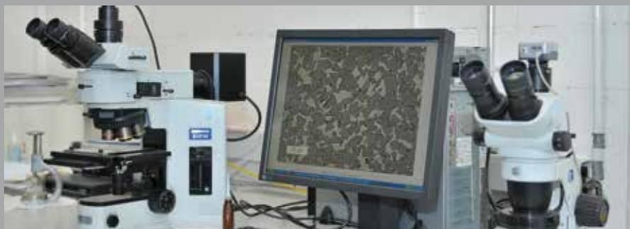
L'assurance de la qualité est un élément essentiel de la fabrication de carbures. Le contrôle métallurgique permet de garantir que les carbures correspondent aux spécifications demandées. Il est fait tout au long du processus de la fabrication, mais aussi avant la livraison des produits frittés. Il est aussi indispensable pour l'analyse de casses et pour l'amélioration des nuances existantes et le développement de nouvelles nuances de carbure au sein de l'activité R&D.
