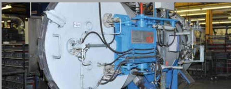
La maison HARTMETALL ESTECH AG dispose de trois installations Sinter-HIP. Les ébauches y sont frittées à une température de 1400°C environ et une pression de 50 bars, un processus qui provoque une réduction de leur volume de la moitié. Le calcul précis de cette rétraction garantit que les ébauches auront exactement les dimensions souhaitées.
