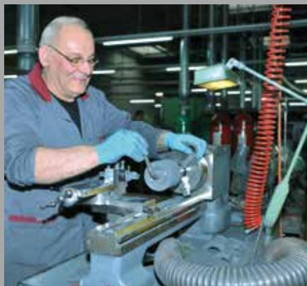
Nos employés de l'atelier de formage façonnent les ébauches pressées et pré-frittées sur des tours conventionnels et sur des machines CNC, à l'aide d'outils diamantés et polycristallin. Le façonnage précis des ébauches, sensibles à la rupture, nécessite une extrême attention et une bonne compréhension des dessins techniques.
