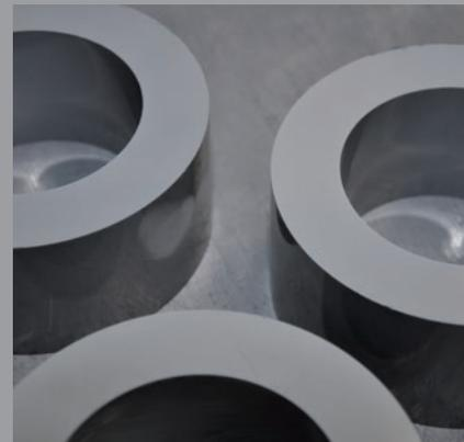
Die fertig geformten Hartmetall-Grünlinge warten auf die Freigabe zum Sintern. Diese erfolgt nach einer umfassenden masslichen Prüfung aller Dimensionen gemäss Produktionszeichnung sowie der metallurgischen Kontrolle der Probekörper derselben Charge.
