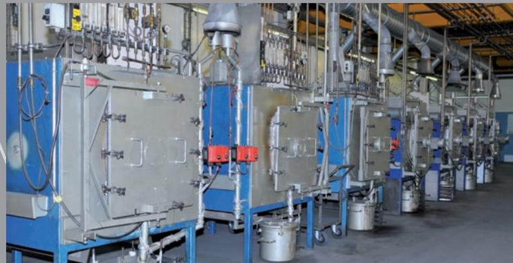
Die Kammeröfen der Vorsinterung dienen dem Entwaschen und der Vorverfestigung der gepressten Hartmetall-Grünlinge. Die richtige Einstellung von Temperatur, Haltezeit und Gas-Atmosphäre ist Voraussetzung für einen stabilen Kohlenstoffhaushalt der Hartmetalle.
