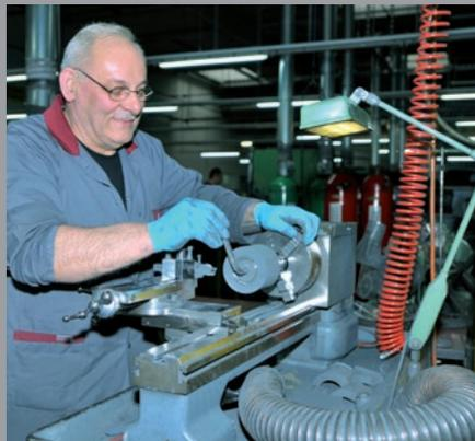
Die Mitarbeiter der Formerei bearbeiten die gepressten und vorgesinterten Hartmetall-Grünlinge auf konventionellen Drehbänken und CNC-gesteuerten Maschinen mit Diamant- und PKD-Werkzeugen. Die genaue Formgebung der bruchempfindlichen Grünlinge erfordert ein hohes Mass an Sorgfalt und das Verstehen von technischen Zeichnungen.
