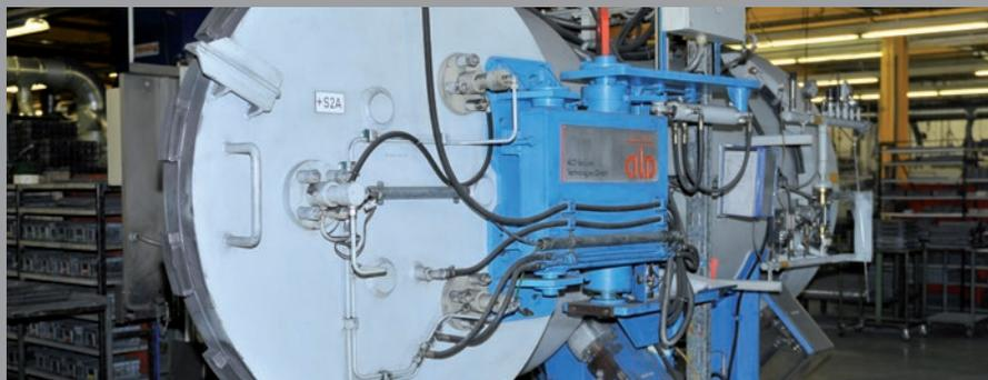
Die HARTMETALL ESTECH AG verfügt über drei sogenannte Sinter-HIP-Anlagen. Hier werden die Grünlinge bei Temperaturen von ca. 1400°C und einem Druck von 50 bar fertig gesintert, wobei sie sich auf die Hälfte des Grünlings-Volumens zusammen ziehen. Die präzise Voraussage des Schwundverhaltens ist entscheidend dafür, dass die Rohlinge die geforderte Masshaltigkeit erreichen.
