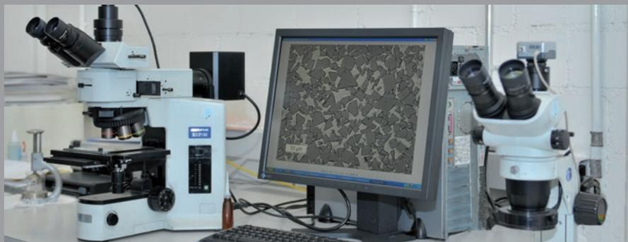
Bei der Herstellung von Hartmetallen spielt die Qualitätssicherung eine entscheidende Rolle. Die metallurgische Produktionskontrolle prüft die Konformität der Hartmetalle zu den Spezifikationsvorgaben während allen Prozessschritten sowie vor dem Versand der gesinterten Hartmetallteile. Sie ist zudem von Bedeutung bei der Schadenanalyse sowie bei der Entwicklung neuer Hartmetallsorten im Rahmen der Forschung und Entwicklung.
